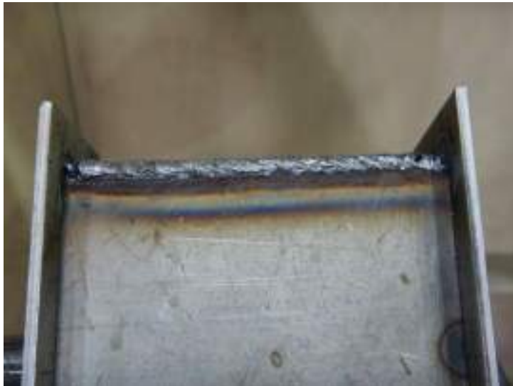
凹、平ビードは加圧時の引張りに弱い
